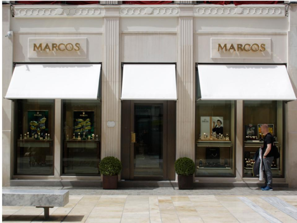
✓ Toldos correctamente colocados en la parte superior del hueco anclándose en la parte interior de este y no sobre el paramento, sin perjudicar elementos arquitectónicos, manteniendo cromatismos de fachada, y sin publicidad sobre la lona.
