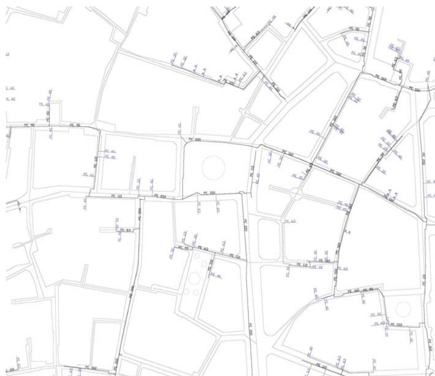
Detalle de la red de distribución de Gas Natural
