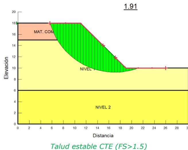
**Talud en terraplén (NIVEL 0 sustituido por materiales compactados): 3H/2V**
