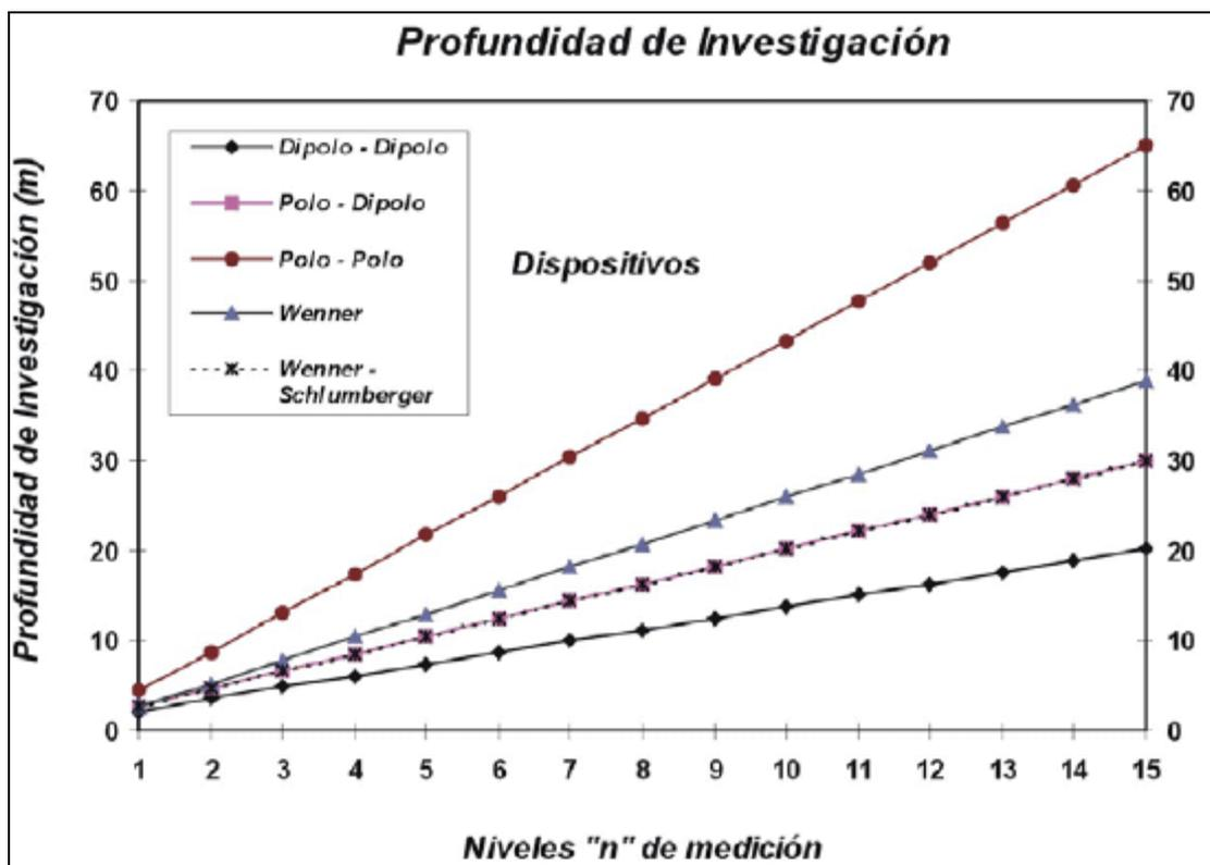
**Figura 7:** Profundidades medias de investigación sobre un medio homogéneo de resistividad para los dispositivos Dipolo-Dipolo, Polo-Dipolo, Polo-Polo, Wenner y Wenner-Schlumberger obtenidas para una distancia interelectrónica de 5 metros y distintos niveles de medición (Edwards, 1977).
