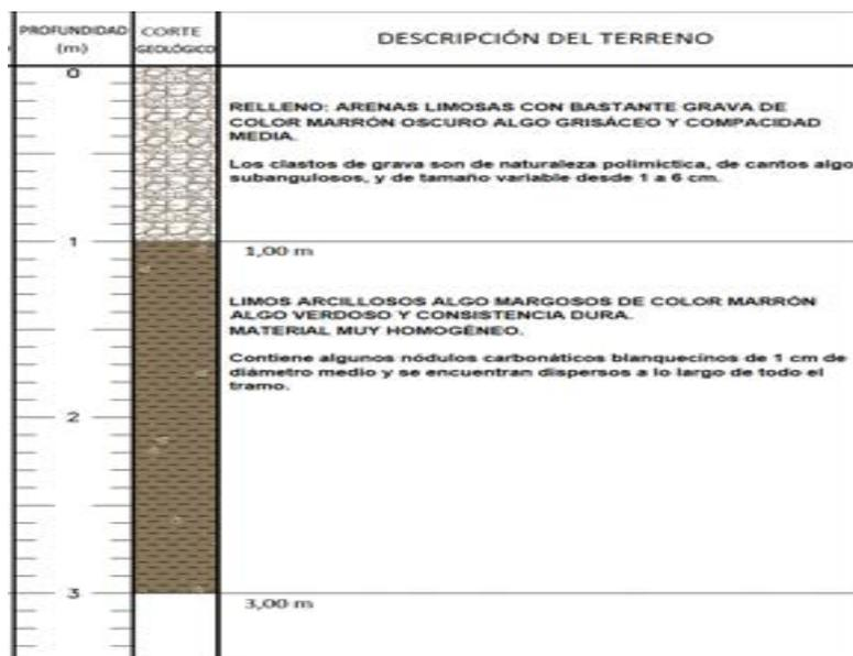
**Ilustración 12: Análisis de la geotecnia**
