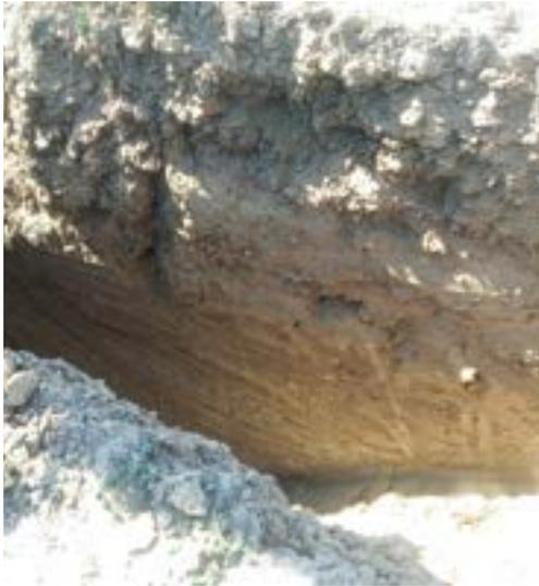
**Ilustración 23:** Imagen donde se observa el relleno antrópico y su contacto con el nivel de arcillas.
