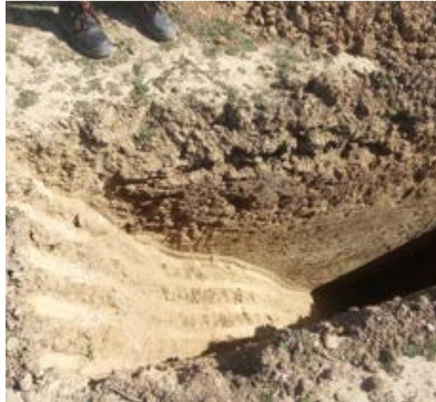
**Ilustración 24:** Imagen donde se observa perfectamente las líneas de contacto entre los diferentes estratos.
