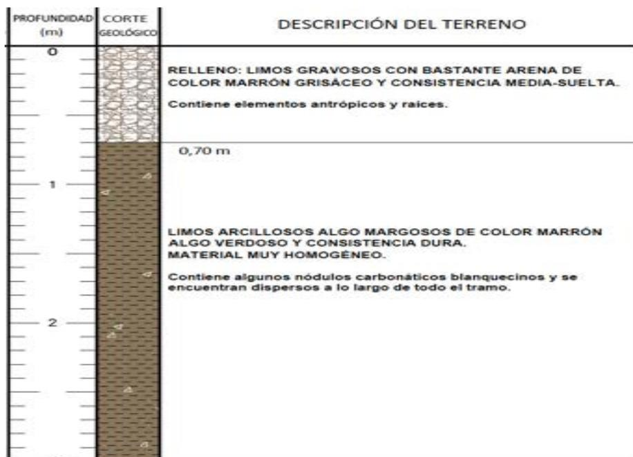
**Ilustración 7: Descripción de la geotecnia.**
