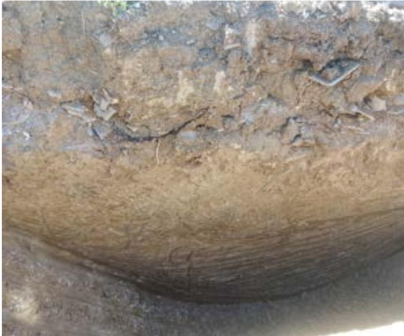
**Ilustración 16: Relleno contemporáneo donde se observa el vertido de uralitas sobre el nivel geológico.**
