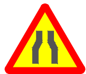
TP-17 ESTRECHAMIENTO DE CALZADA
