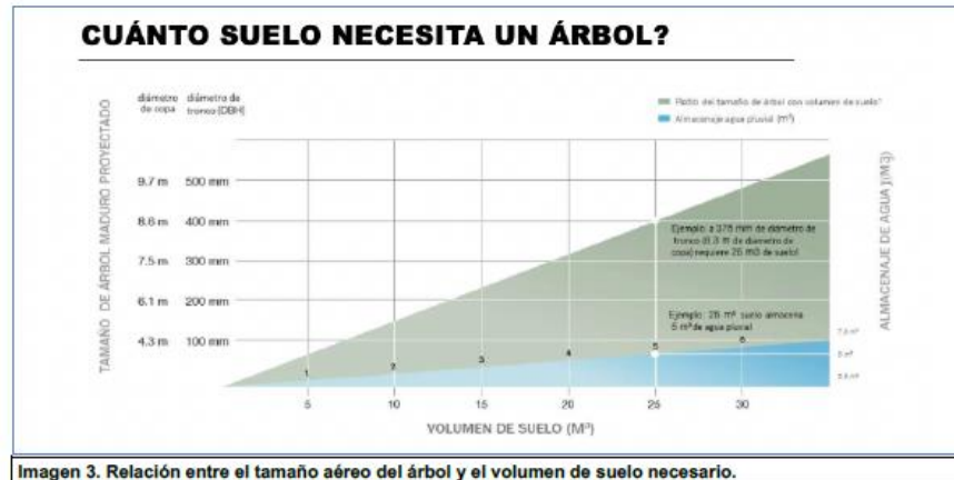
Imagen 3. Relación entre el tamaño aéreo del árbol y el volumen de suelo necesario.
