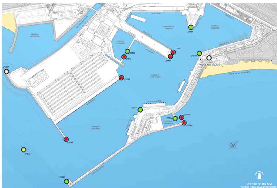
Figura nº1.- Balizamiento interno Puerto de Málaga
