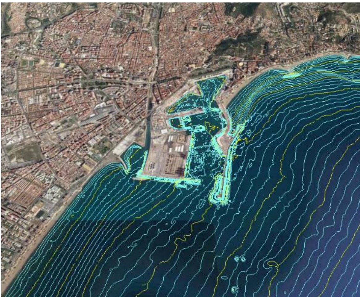
Imagen: batimetría Puerto de Málaga
