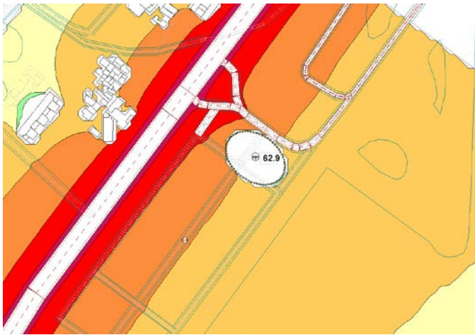
Figura 12: Alternativa 3. Situación operacional. L_d (dBA) a 4 m
