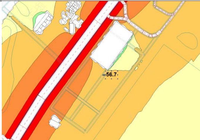
Figura 7: Alternativa 3. Situación preoperacional. L_e (dBA) a 4 m
