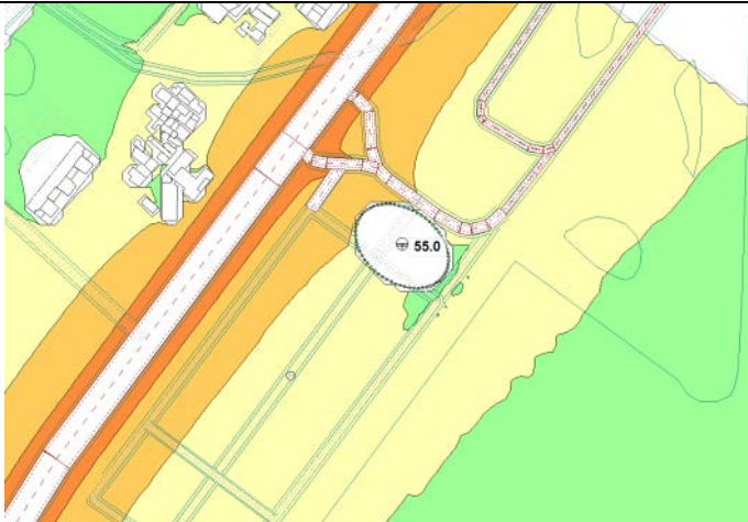
Figura 14: Alternativa 3. Situación operacional. L_n (dBA) a 4 m
