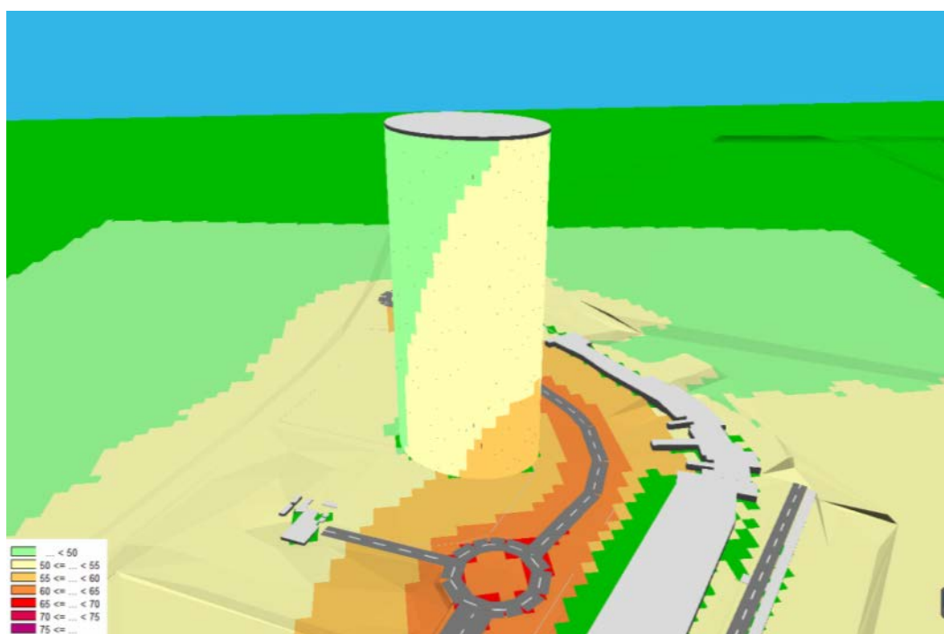
Figura: Alternativa 1. Nivel de inmisión en fachada de futuro edificio terciario. L d (dBA)
