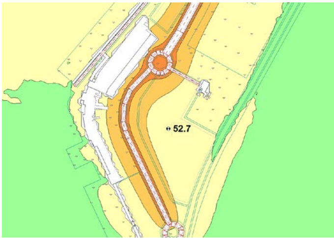
Figura 3: Alternativa 1. Situación preoperacional. L_d (dBA) a 4 m
