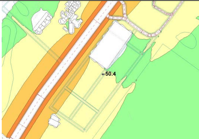
Figura 8: Alternativa 3. Situación preoperacional. L_n (dBA) a 4 m
