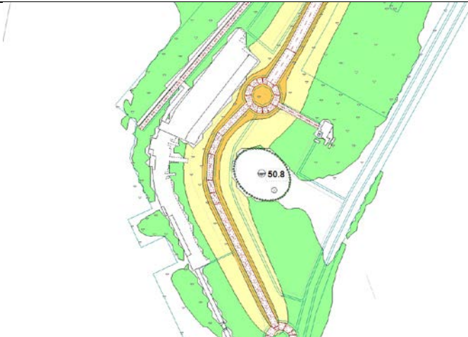
Figura 11: Alternativa 1. Situación operacional. L_n (dBA) a 4 m
