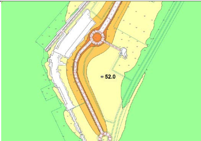
Figura 4: Alternativa 1. Situación preoperacional. L_e (dBA) a 4 m
