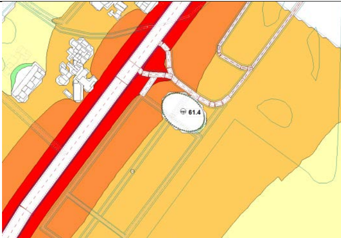
Figura 13: Alternativa 3. Situación operacional. L_e (dBA) a 4 m
