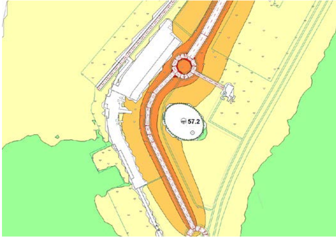
Figura 9: Alternativa 1. Situación operacional. L_d (dBA) a 4 m
