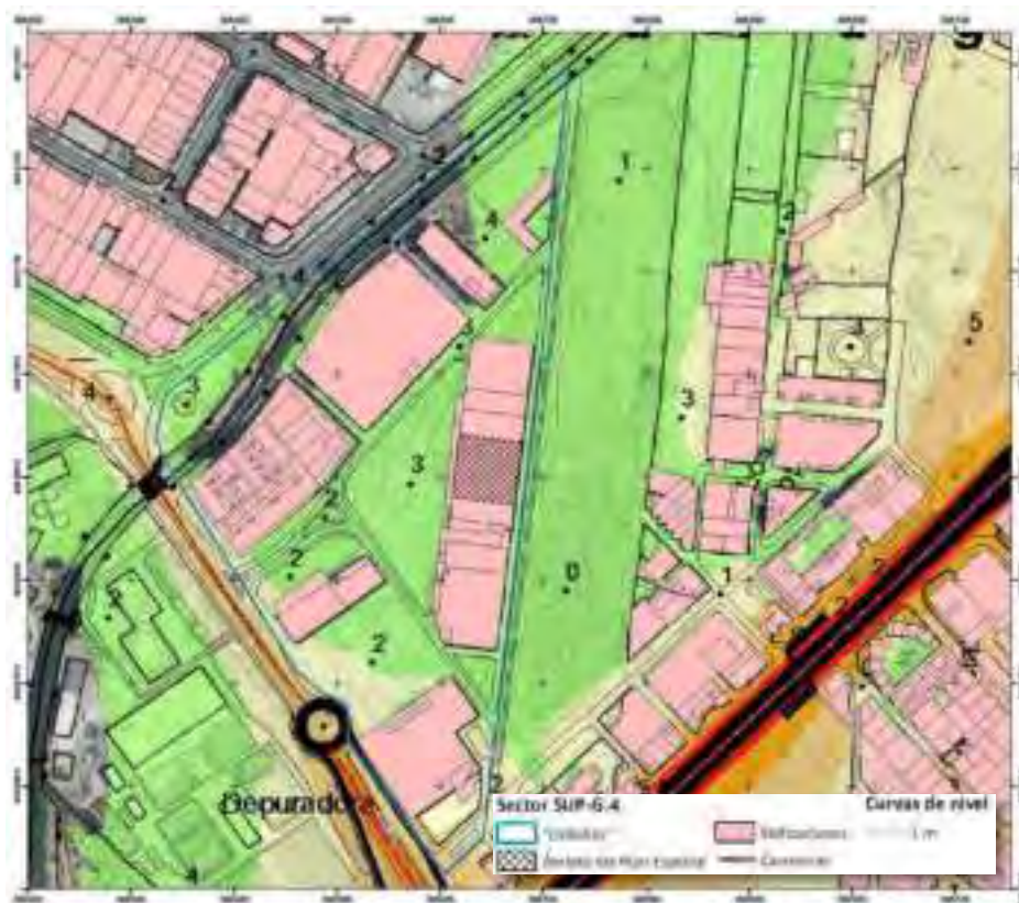
Ilustración 16. Situación operacional. Noche Ln (dBA) a 4 m.
