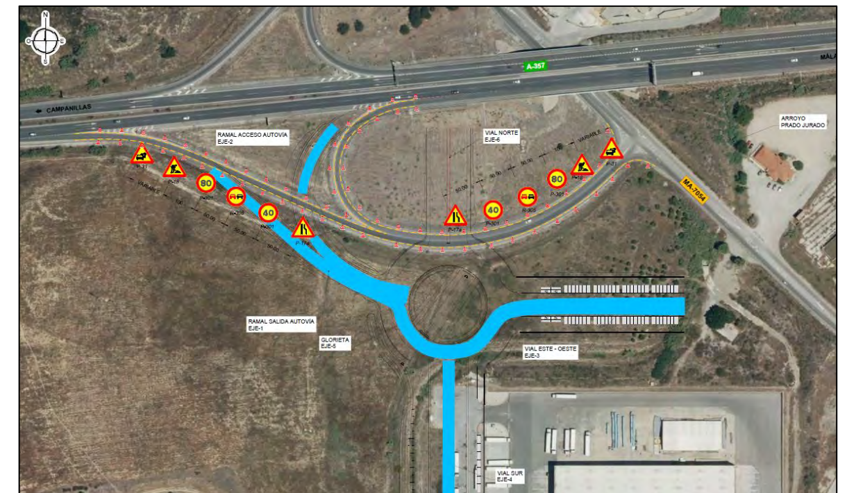
Ilustración 21: Esquema de la Fase 1. En azul los tramos que se ejecutarían durante esta fase.
