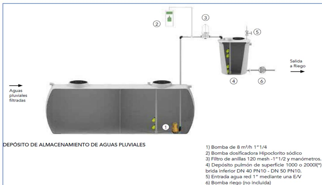
Desde el depósito de almacenamiento, las aguas serán bombeadas a un segundo depósito, y durante el bombeo se filtra el agua con un filtro de anillas y se clora ligeramente dosificando hipoclorito sódico. Desde aquí el agua ya tratada se distribuirá mediante la red de riego prevista en el Sector.
