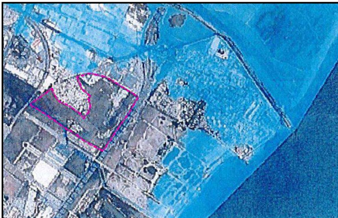
*Imagen. Mancha de inundación máxima según el modelo hidráulico. Imagen extraída del informe en materia de Aguas sobre el documento de PPO SUS G-1 San Julián (anexo 2)*
