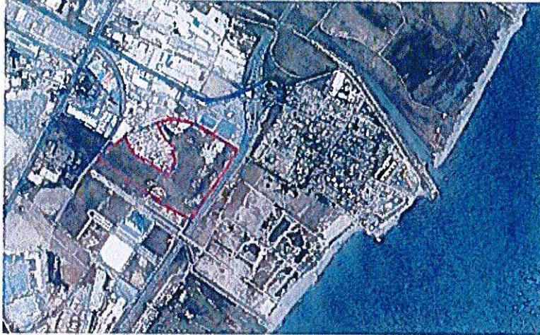
La cota de inundación en el frente de avance de la inundación hacia el SUS-G1 ha resultado ser del orden de +4,50 a +4,70 msnm., por lo que se propone elevar el SUS-G1 en esta zona hasta +5,00 msnm, dejando así un resguardo mínimo +0,30 m.
