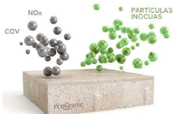
**Ilustración 23** Fotocatalización del pavimento absorbente. Fuente empresa PVT, EcoGRANIC (2017).
