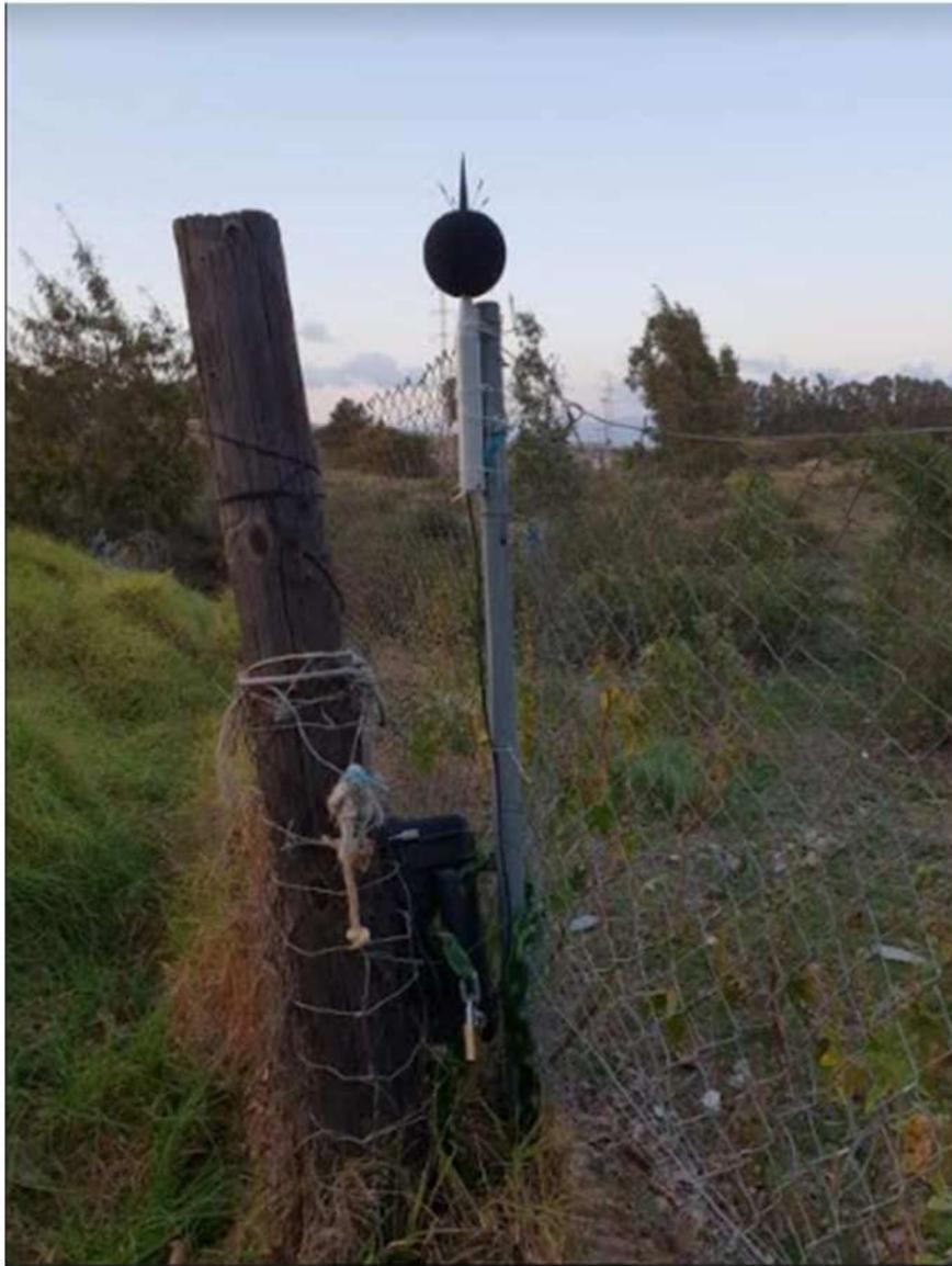
*Imagen. Sonómetro utilizado en los ensayos.*
