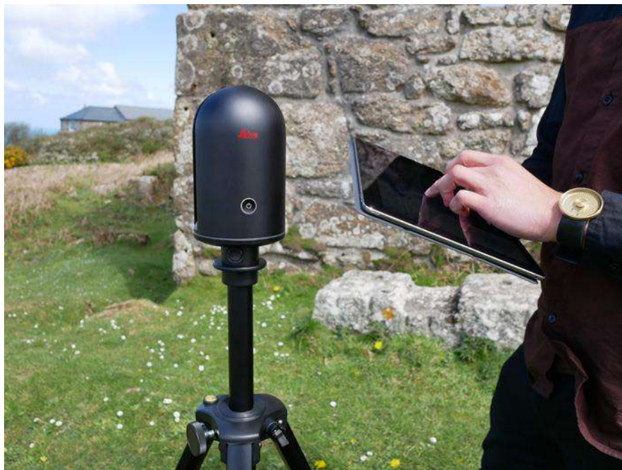
Figura Nº 42.- Equipo de Laser Scan.
