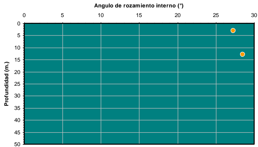
Figura Nº 54.- Valores de ángulo de rozamiento interno en relación a la profundidad.
