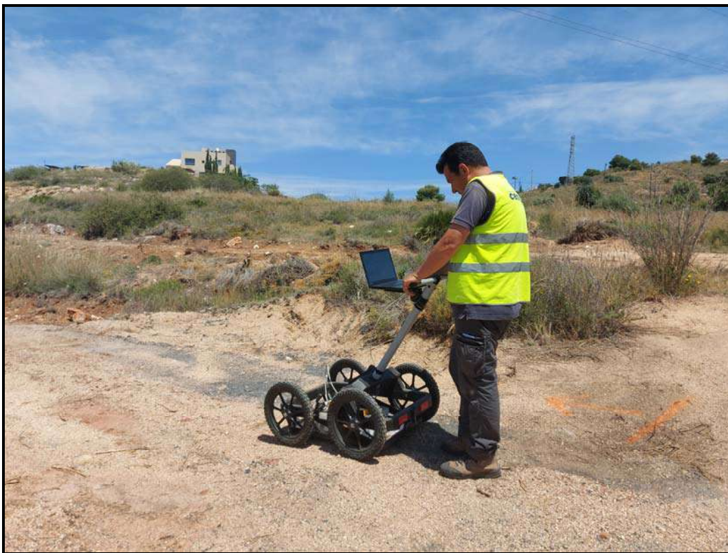
Fotografía 2.- Registro continuo con Georadar.
