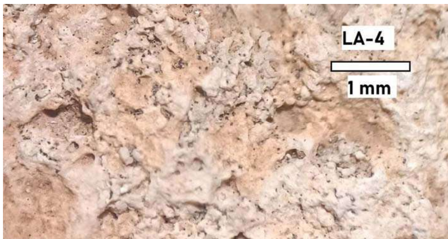
MUESTRA LA-4. IMAGEN DE LUPA BINOCULAR. DESTACA EL GRADO DE CEMENTACIÓN DEL SEDIMENTO, LAS MICAS OSCURAS Y LA MICROKARSTIFICACIÓN PRESENTES
