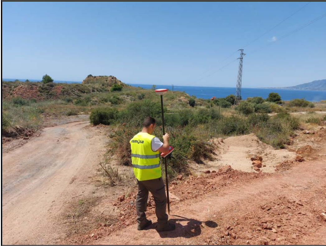
Fotografía 1.- Toma de datos de campo con GPS centimétrico.
