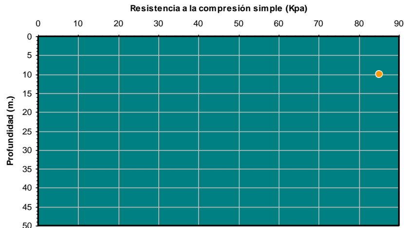
Figura Nº 52.- Valores de compresión simple en relación a la profundidad.
