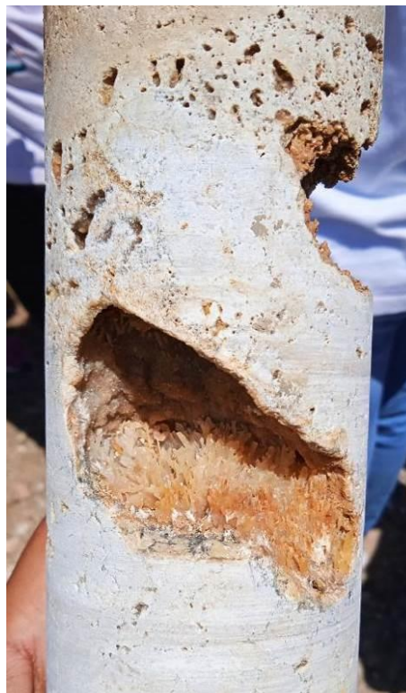
Figura Nº 104.- Ejemplo de procesos de karstificación con desarrollo de mineralizaciones calcíticas y espeleotemas en el sondeo S-21 entre los 7.90-8.40m de profundidad.
