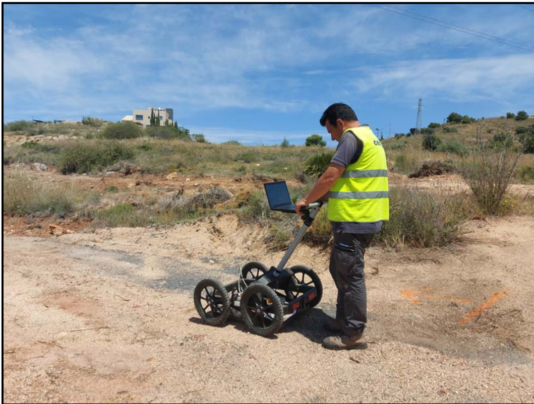
Fotografía 2.- Registro continuo con Georadar.
