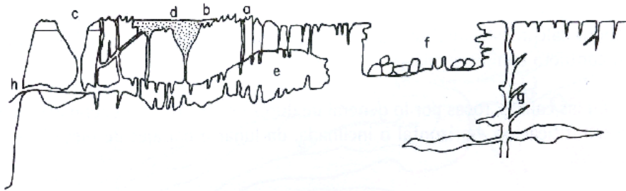
Figura Nº 103.- Morfología de un macizo calcáreo. a) Lapiaz desnudo. b) Lapiaz cubierto. c) Dolina. d) Dolina cubierta. e) Cueva. f) Torca. g) Sima. h) Fuente.
