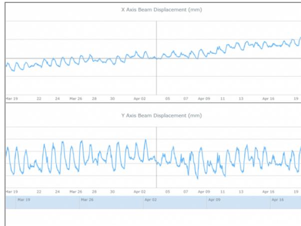
Podremos variar la frecuencia de lectura de los sensores, de forma remota e inmediata, según requiera la acción que se esté realizando. Instalaremos el sistema antes de empezar las intervenciones, de tal forma que podremos modelar el comportamiento del edificio por efectos como las variaciones de temperatura. De igual forma, una vez finalizados los trabajos, los equipos se mantendrán hasta certificar la estabilidad de la estructura.
