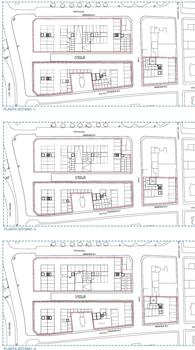
La construcción de tres/cuatro niveles de sótano implica realizar excavaciones muy profundas para ubicar la cimentación de las edificaciones con las importantes dificultades constructivas que conlleva, teniendo en cuenta además que existen edificios antiguos muy próximos.
