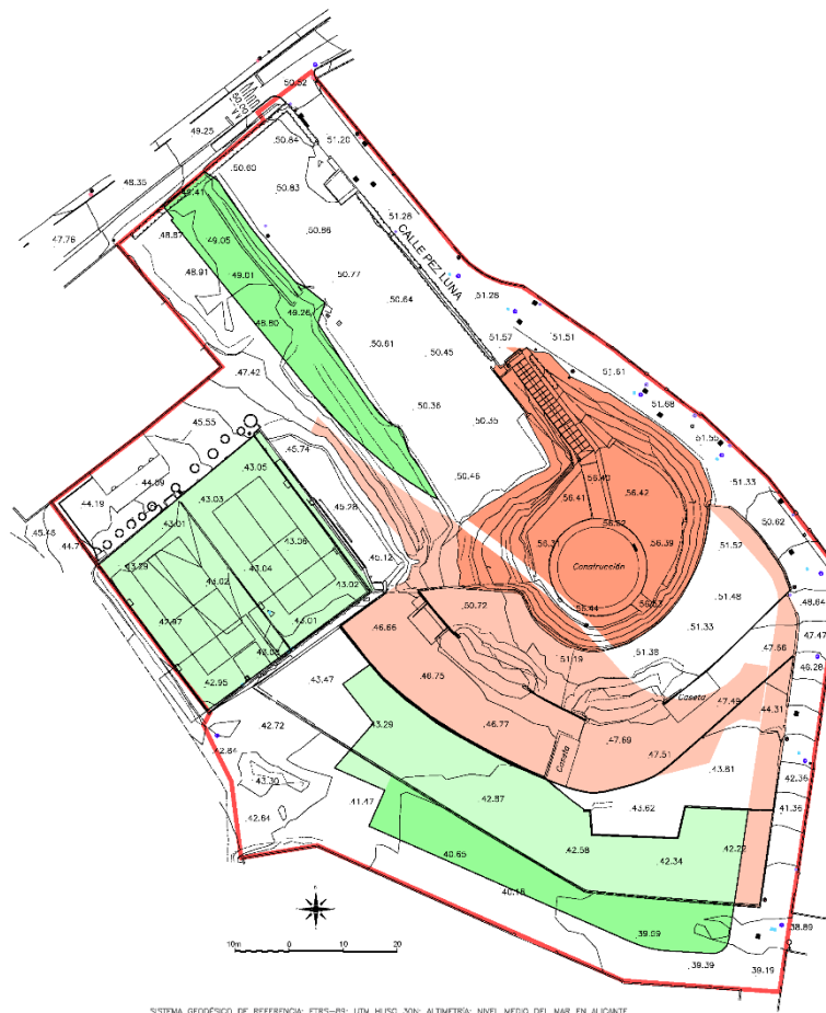
ESQUEMA DE DESMONTES (ROJO) Y RELLENOS (VERDE) EN EL AMBITO DE ACTUACIÓN
