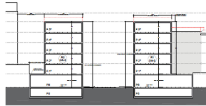
Imagen 7. Sección. Alturas sobre y bajo rasante
