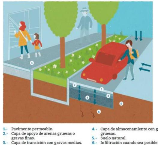
Se ha previsto implementar este sistema en la nueva bahía de aparcamientos denominada P8, junto a la nueva Ampliación comercial proyectada. Su punto final estará conectado con la red de pluviales convencional del sector, de tal forma que el caudal de exceso no infiltrado será vertido a red pública.
