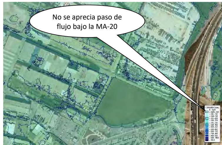
Ilustración 30. Recorte del Estudio para la Prevención de Inundaciones y Ordenación de la Cuenca del Guadalhorce, con la mancha de inundación para periodo de retorno de 500 años.
