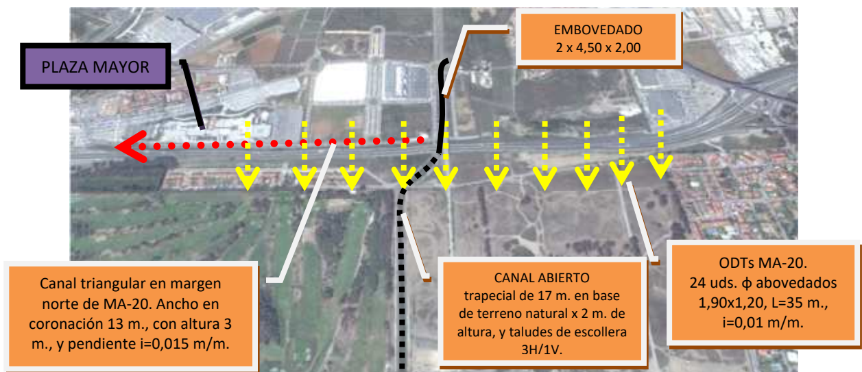
Ilustración 15. Circulación de flujos a través de la MA-20, y definición de sus estructuras.
