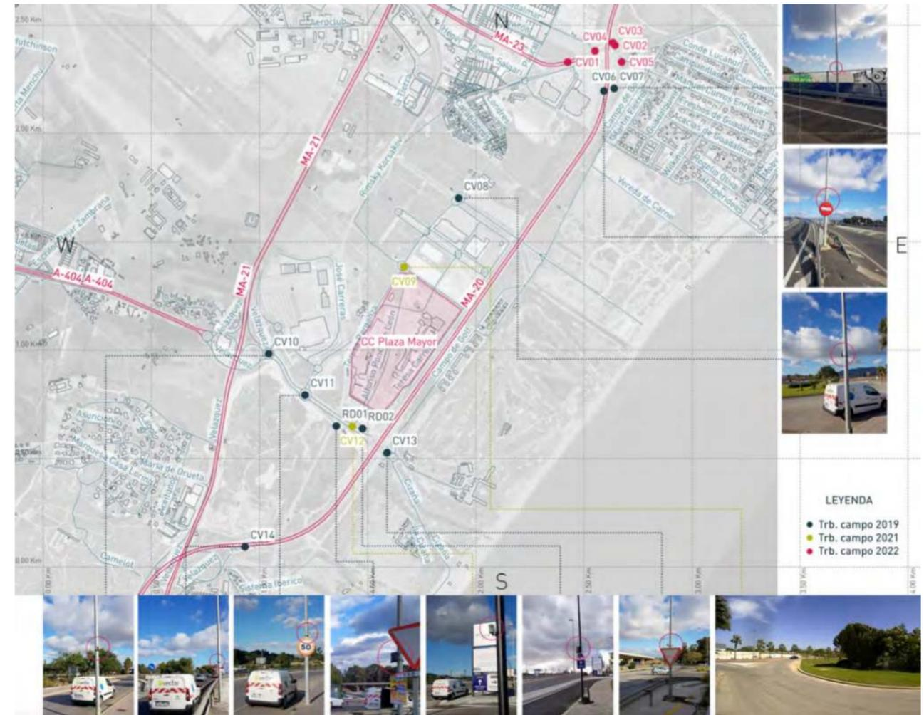
Imagen 3. Ubicación de las cámaras de visión artificial instalados para la realización del presente estudio.
