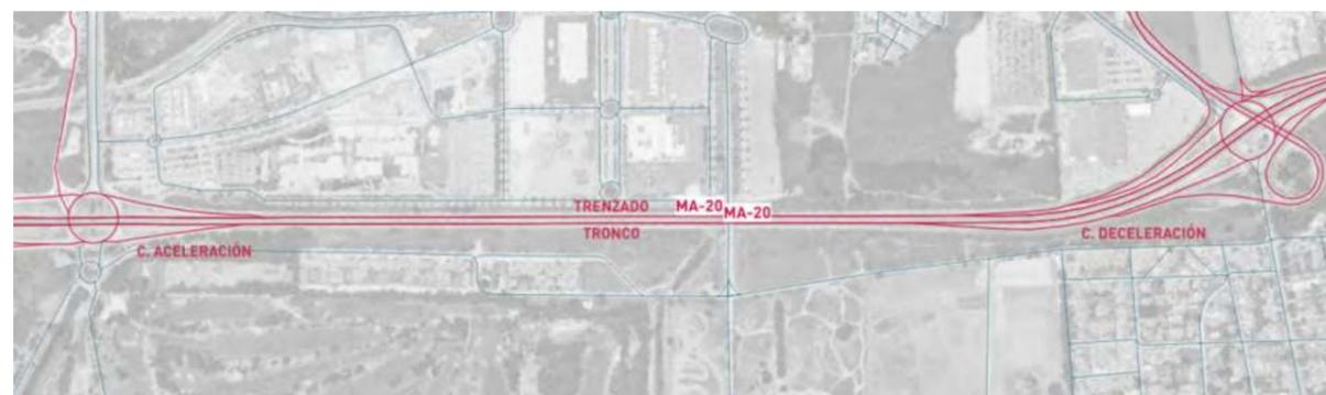
Imagen 67. Secciones de cálculo de niveles de servicio en MA-20.
