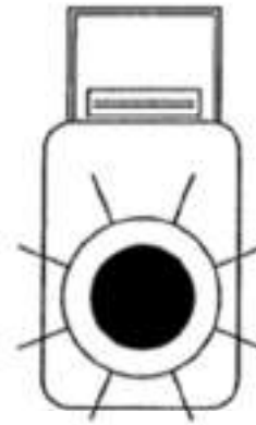
Baliza intermitente destellante con célula fotoeléctrica
