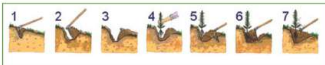
Técnica de plantación con Azada de boca estrecha
