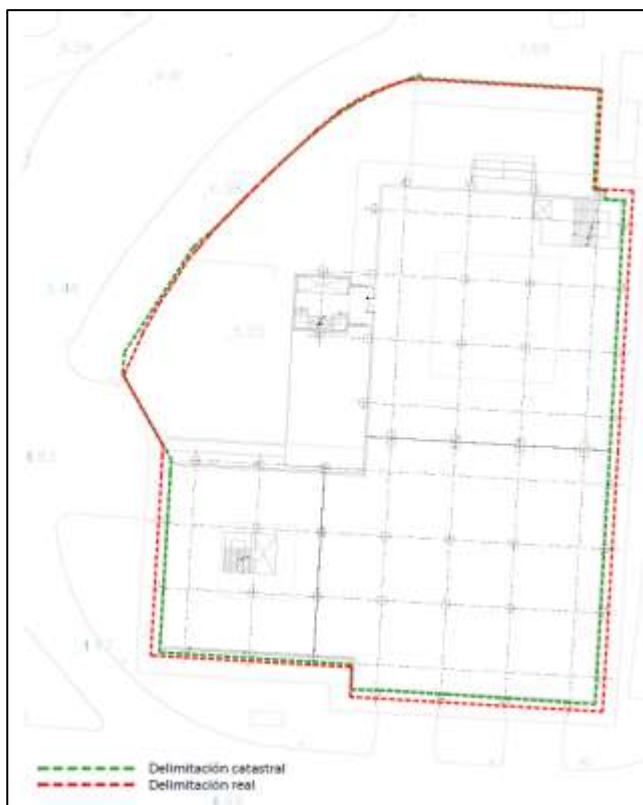
Imagen de Google Maps donde se observa la parte del edificio con los pilares externos sobre la “acera privada” no computada en la superficie de la parcela catastral
