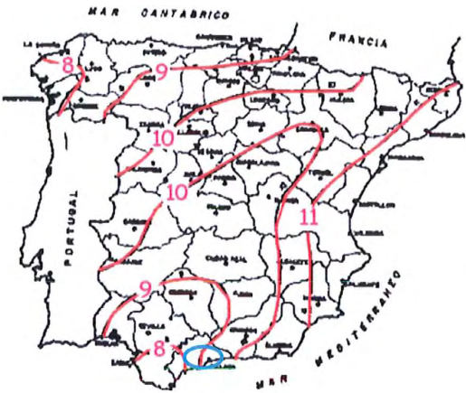
Ilustración 12. Relación entre la intensidad horaria de precipitación y la intensidad media diaria
