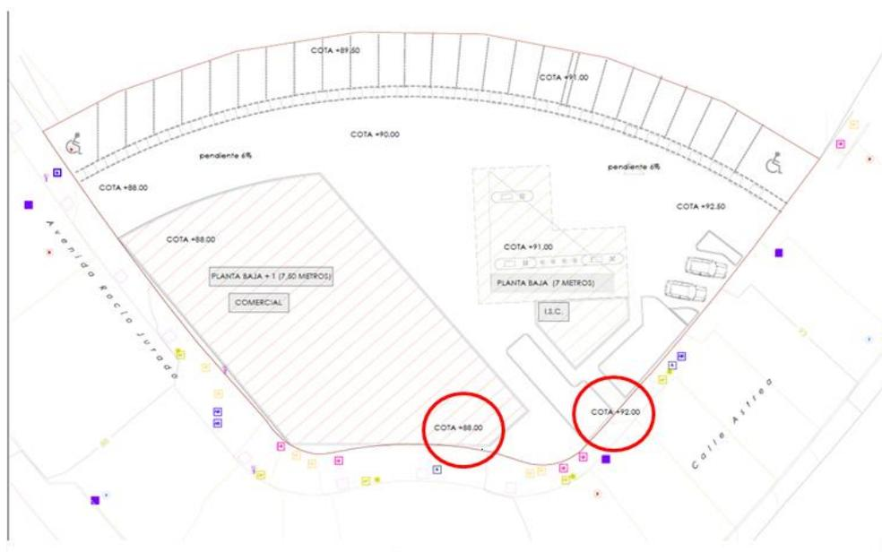
El nuevo documento presentado incluye el plano 13. PLATAFORMAS. ALTURAS Y RASANTES. SECCIONES, donde se señalan las zonas que requieren muros de contención del terreno.
