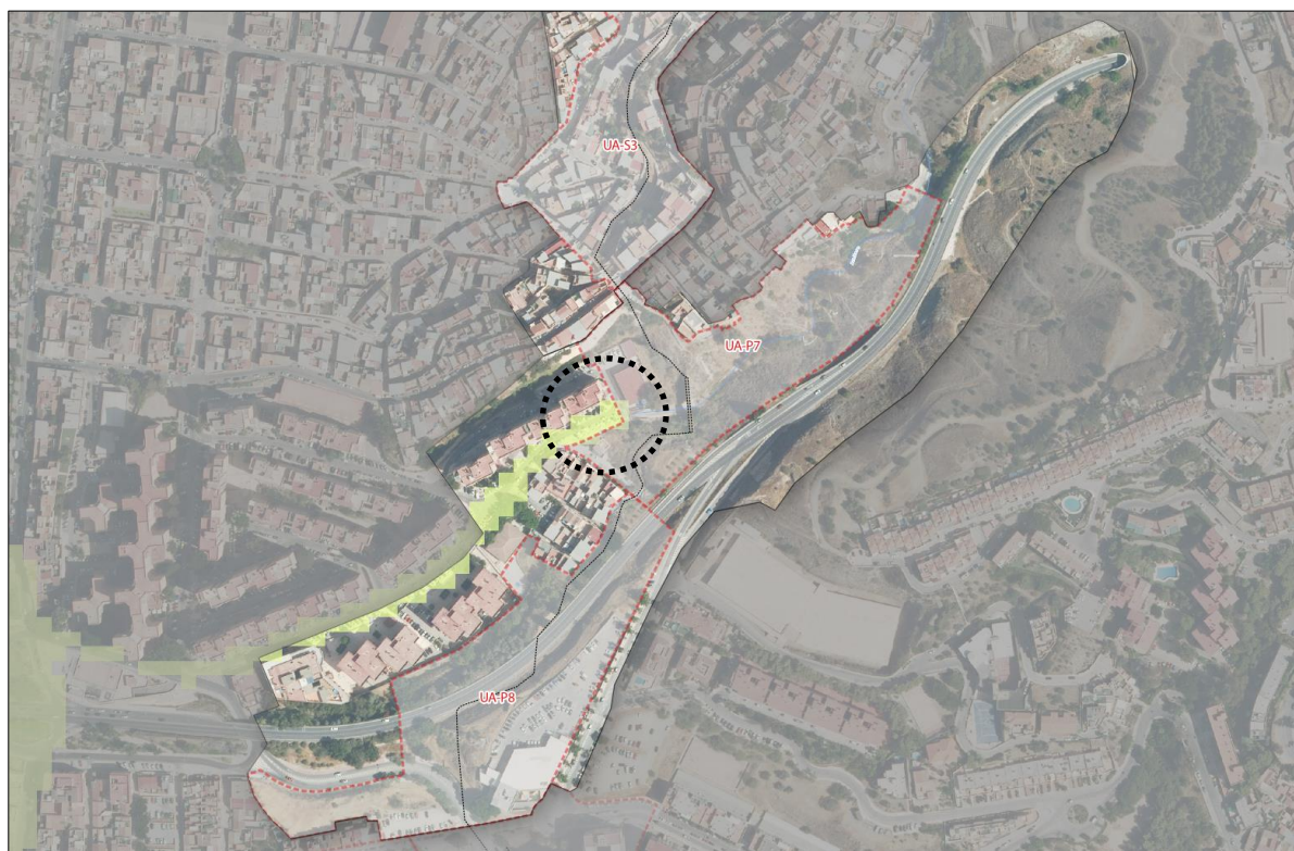
Figura 53. Pequeñas áreas (píxeles) de riesgo Medio de inundación debido al arroyo Aceitero a su paso por la Unidad de Actuación UA-P7, perteneciente a la UA-5. Fuente: PAL de Inundaciones municipal. Servicio de Protección Civil de Málaga.
