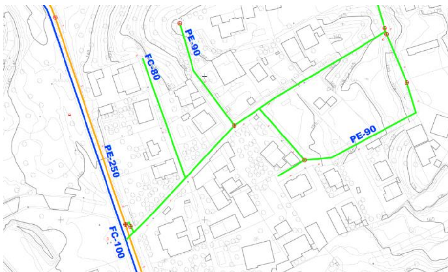
Ilustración 4 - Conexión existente red de abastecimiento de agua potable.
