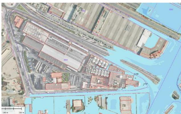
Fig 6. Afección por inundabilidad (Extensión de las Zonas Inundables T-500) según documento de Avance
