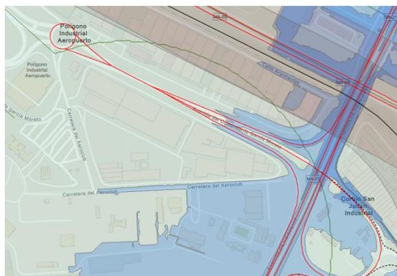
Fig 5. Afección por inundabilidad (Extensión de las Zonas Inundables T-500) según Visor del Ministerio
