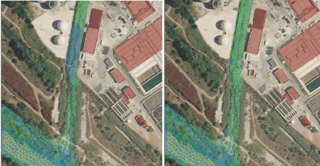
A las 7h30 de simulación, el Arroyo de las Cañas tiene un caudal de entrada de 54,5m<sup>3</sup>/s y el río Guadalhorce 335,1 m<sup>3</sup>/s, lo que supone prácticamente la tercera parte del caudal máximo en el caso del arroyo y la décima parte del caudal máximo en el caso del río.
