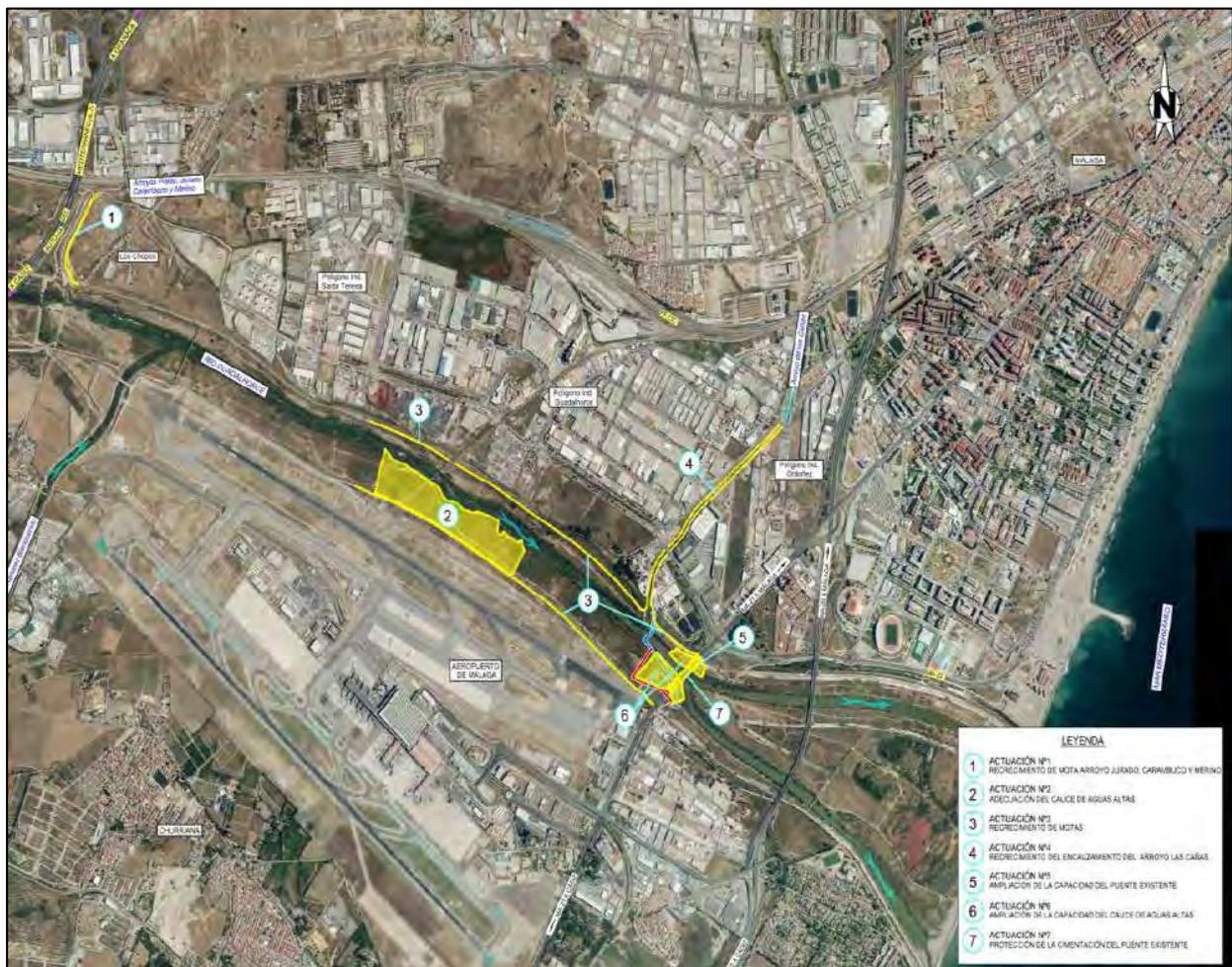
**Figura 2-7:** Recrecido encauzamiento Arroyo de las Cañas en el tramo final de la EDAR realizado en la obra de las actuaciones de defensa del río Guadalhorce frente a las inundaciones en el T.M de Málaga.
