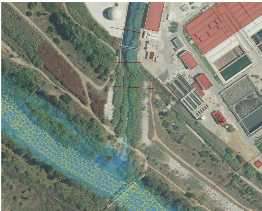
Hasta las 7h30 de simulación en el encauzamiento del Arroyo de las Cañas tiene capacidad para transportar las aguas sin desbordarse.
