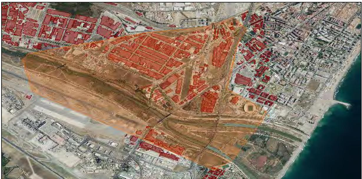
En el modelo se ha considerado una **zona de simulación bidimensional** de 659,5 ha, con una longitud máxima de aproximadamente 4 km (de río Guadalhorce) y ancho de 3,1 km aproximadamente. Engloba el tramo del Arroyo de las Cañas desde el cruce con las vías del ferrocarril hasta su desembocadura (tramo de aproximadamente
