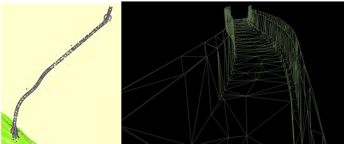
Este levantamiento ha sido introducido en el MDT de la ARPSI. Dada la esbeltez del muro de recrecido del encauzamiento unos 12 cm de espesor, en la digitalización se ha engrosado hasta 1m de espesor para facilitar el mallado y simulación en el programa de modelización hidráulica. Se considera que esta modificación no tendrá una afección significativa a los resultados del mismo.
