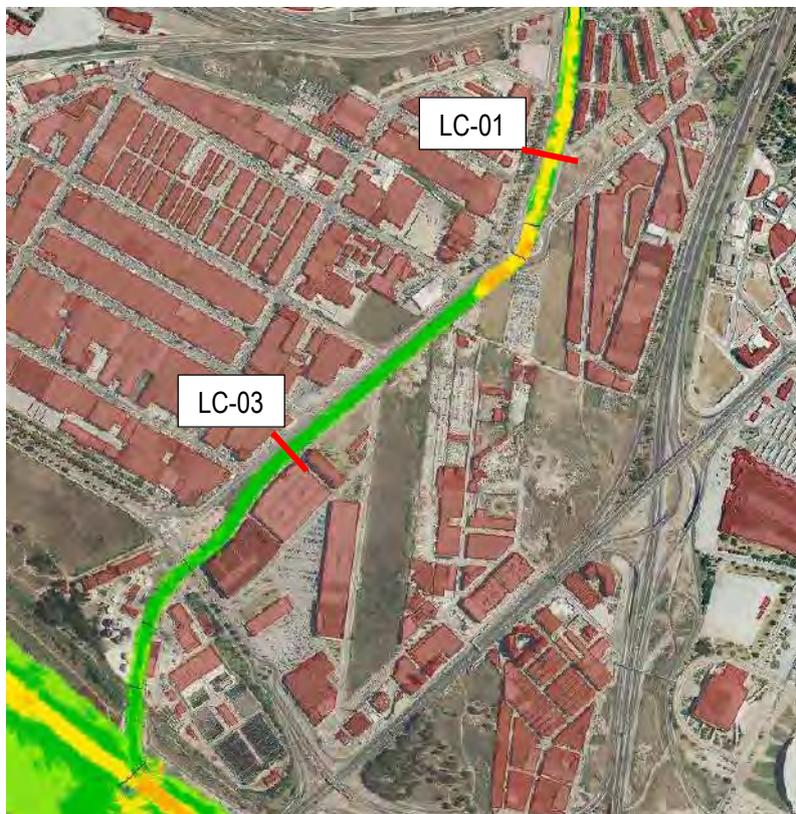
En este momento el agua del arroyo discurre por su cauce. Se observa que en la zona norte (aguas arriba) las aguas tienen una mayor velocidad, obteniendo resultados en la sección de control L-01 (zona intermedia aguas arriba de la rotonda de Herman Hesse) de 1,94m de calado y 1,42m/s de velocidad.
