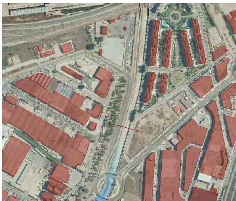
Centrando el análisis en la afección al Parque Comercial Ordoñez - Málaga Nostrum se ve claramente afectado por la inundación de T-500 años debido a la crecida del río Guadalhorce. Se observa que el caudal procedente del arroyo se introduce en el parque comercial por el propio viario de la zona comercial, así como por la Carretera Azucarera-Intelhorce. En la zona del aparcamiento, al aumentar la sección disponible, se reducen las velocidades situándose de forma general por debajo de los 0,5m/s.
