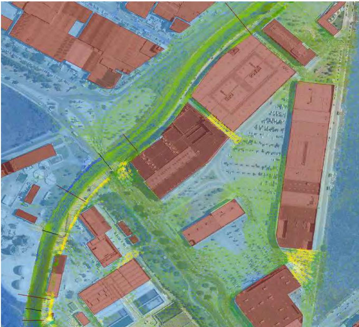
Respecto al calado, en la zona central del aparcamiento existente junto a la futura instalación de servicio de carburante, el calado se sitúa por debajo de un metro, llegando a 1,25m en la fachada del actual edificio que ocupará la futura E.S. De forma general en el parque comercial el calado aumenta tanto por las vías de entrada como hacia la de salida, que se produce principalmente por el vial existente al sur entre el edificio actual que ocupa Bauhaus y la nave del futuro Cine.
