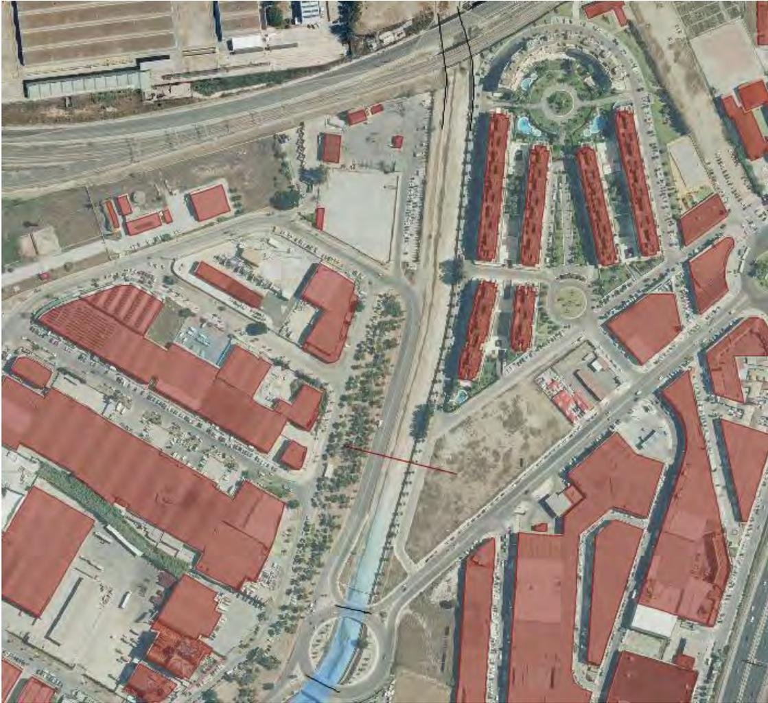
Centrando el análisis en la afección al Parque Comercial Ordoñez - Málaga Nostrum se ve claramente afectado por la inundación de T-500 años debido a la crecida del río Guadalhorce. Se observa que el caudal procedente del arroyo se introduce en el parque comercial por el propio viario de la zona comercial, así como por la Carretera Azucarera-Intelhorce. En la zona del aparcamiento, al aumentar la sección disponible, se reducen las velocidades situándose de forma general por debajo de los 0,5m/s.
