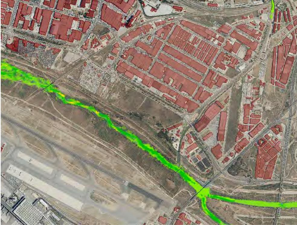
**Figura 2-4:** T-100. Detalle de la desembocadura del Arroyo de las Cañas a las 2h40 donde se observa que el río Guadalhorce circula por el cauce de aguas bajas
