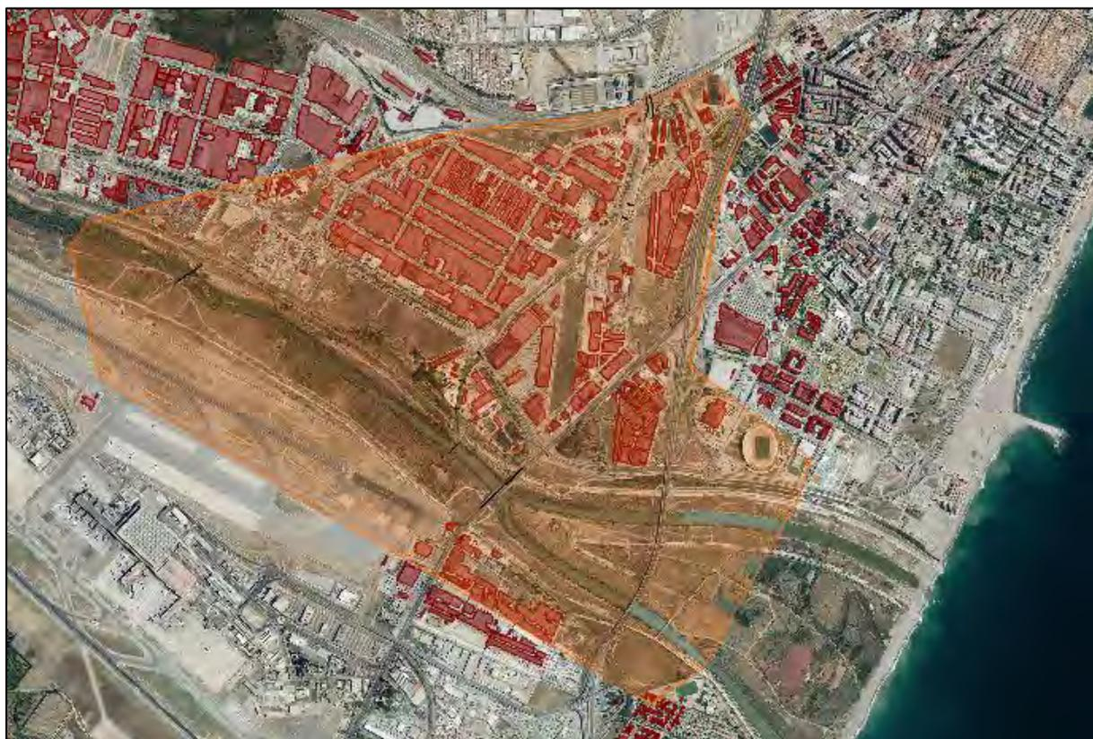
Una vez generada la zona 2D, se han simulado directamente con los caudales de los dos cauces, delimitando así de una forma más precisa las áreas de inundación a partir de la generación de cauces superficiales y las direcciones del agua que devuelve el modelo Infoworks ICM©. Se incluye una planta de resultados en la figura siguiente.
