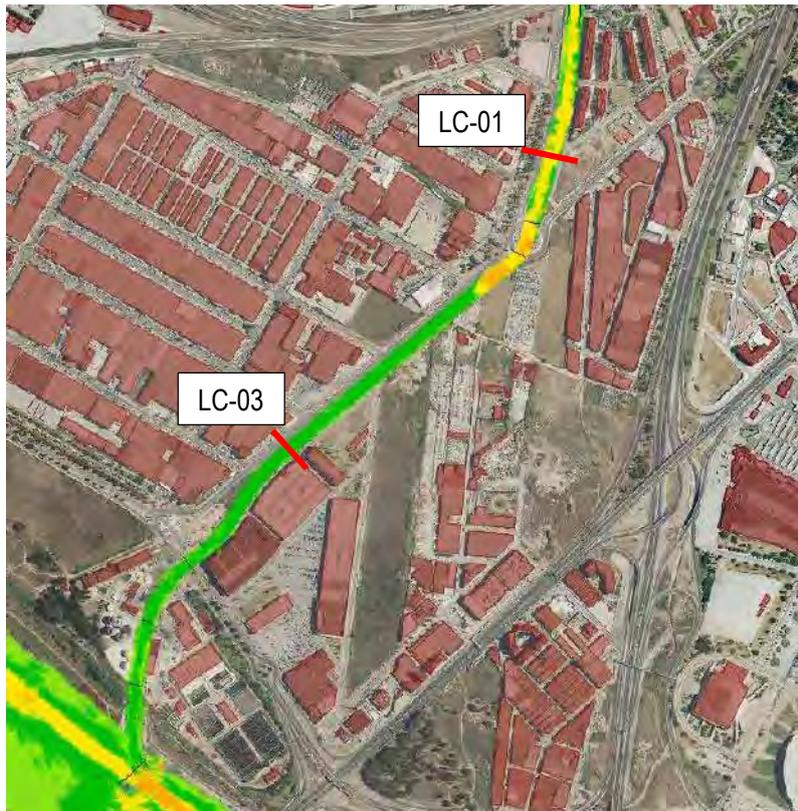
En este momento el agua del arroyo discurre por su cauce. Se observa que en la zona norte (aguas arriba) las aguas tienen una mayor velocidad, obteniendo resultados en la sección de control L-01 (zona intermedia aguas arriba de la rotonda de Herman Hesse) de  $1,94 \text{ m}$  de calado y  $1,42 \text{ m/s}$  de velocidad.
