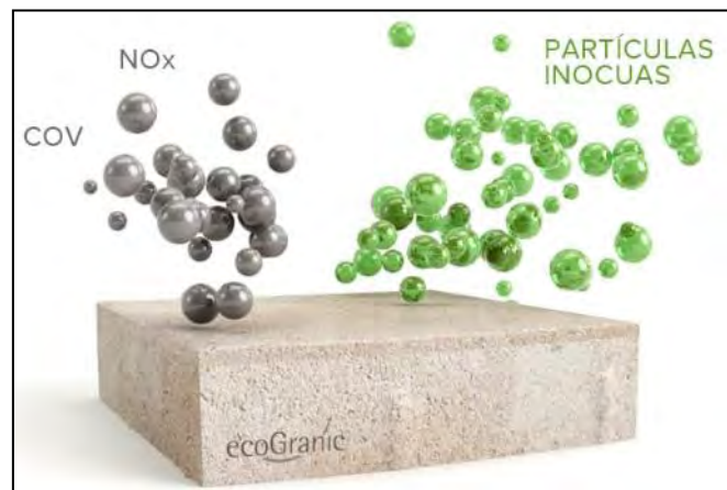
Ilustración 69. Fotocatalización del pavimento absorbente. Fuente empresa PVT, EcoGRANIC (2017).
