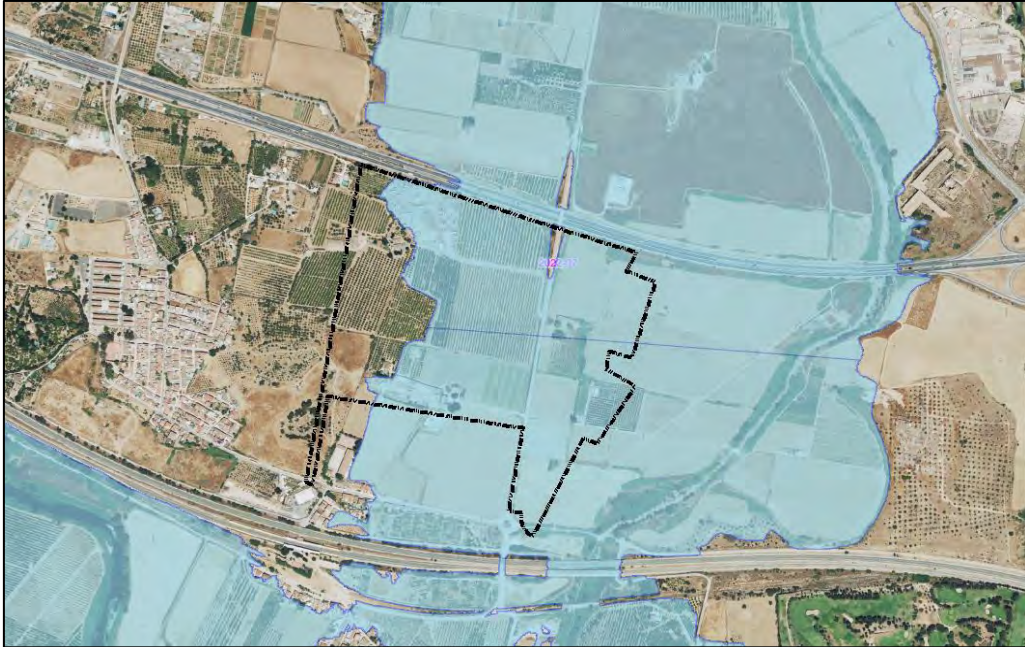
Ilustración 37. Imagen de las zonas inundables del Río Campanillas, periodo de retorno de 500 años.
