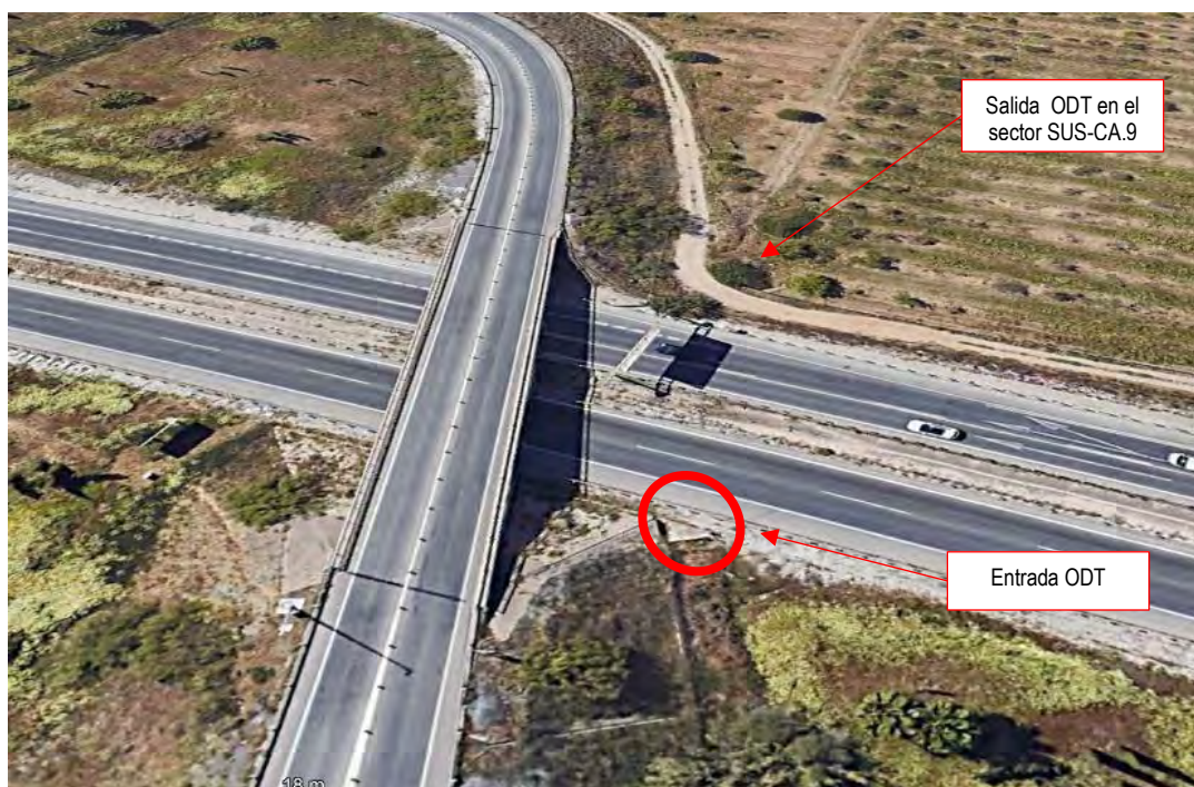
Figura 3-6: ODT Arroyo Innominado en la parcela de actuación e inicio conducto a través de la parcela.
