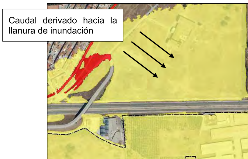
Ilustración 16. Inundación provocada por el mal dimensionamiento del canal.
