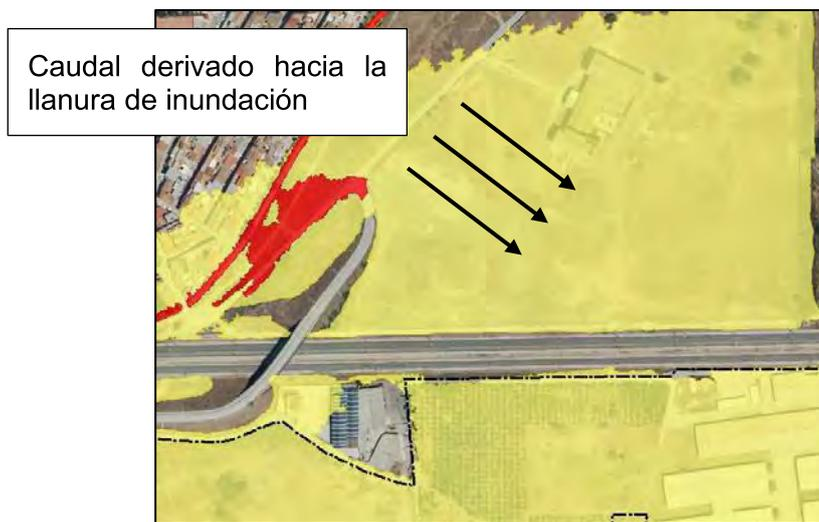
Ilustración 33. *Inundación provocada por el mal dimensionamiento del canal.*
