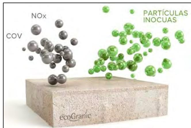
Ilustración 40. Fotocatalización del pavimento absorbente. Fuente empresa PVT, EcoGRANIC (2017).
