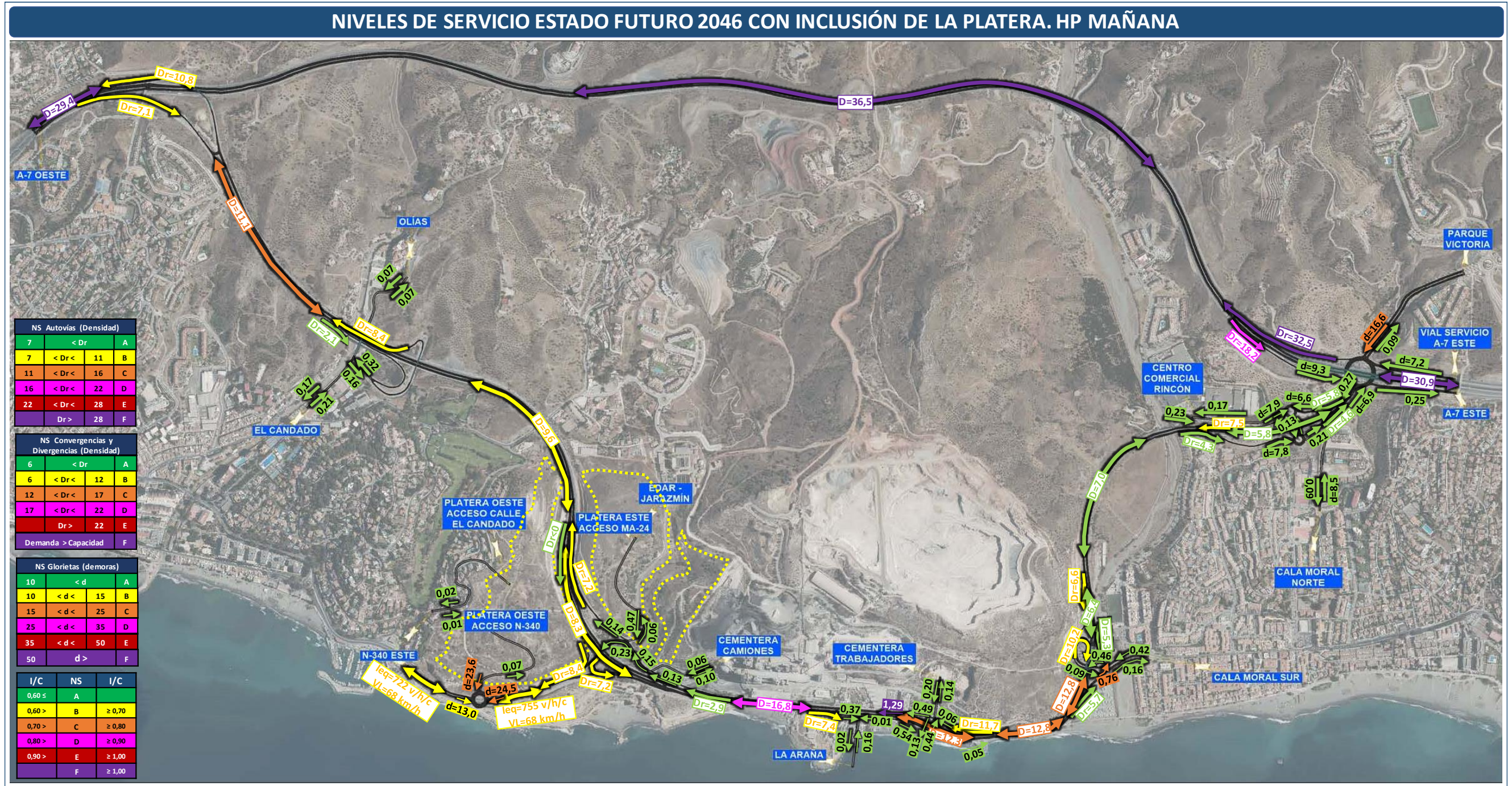
Ilustración 85: Niveles de Servicio en Hora Punta de Mañana para el Año Horizonte (2046), incluyendo el desarrollo del Sector PAM-LE.7 "LA PLATERA".
