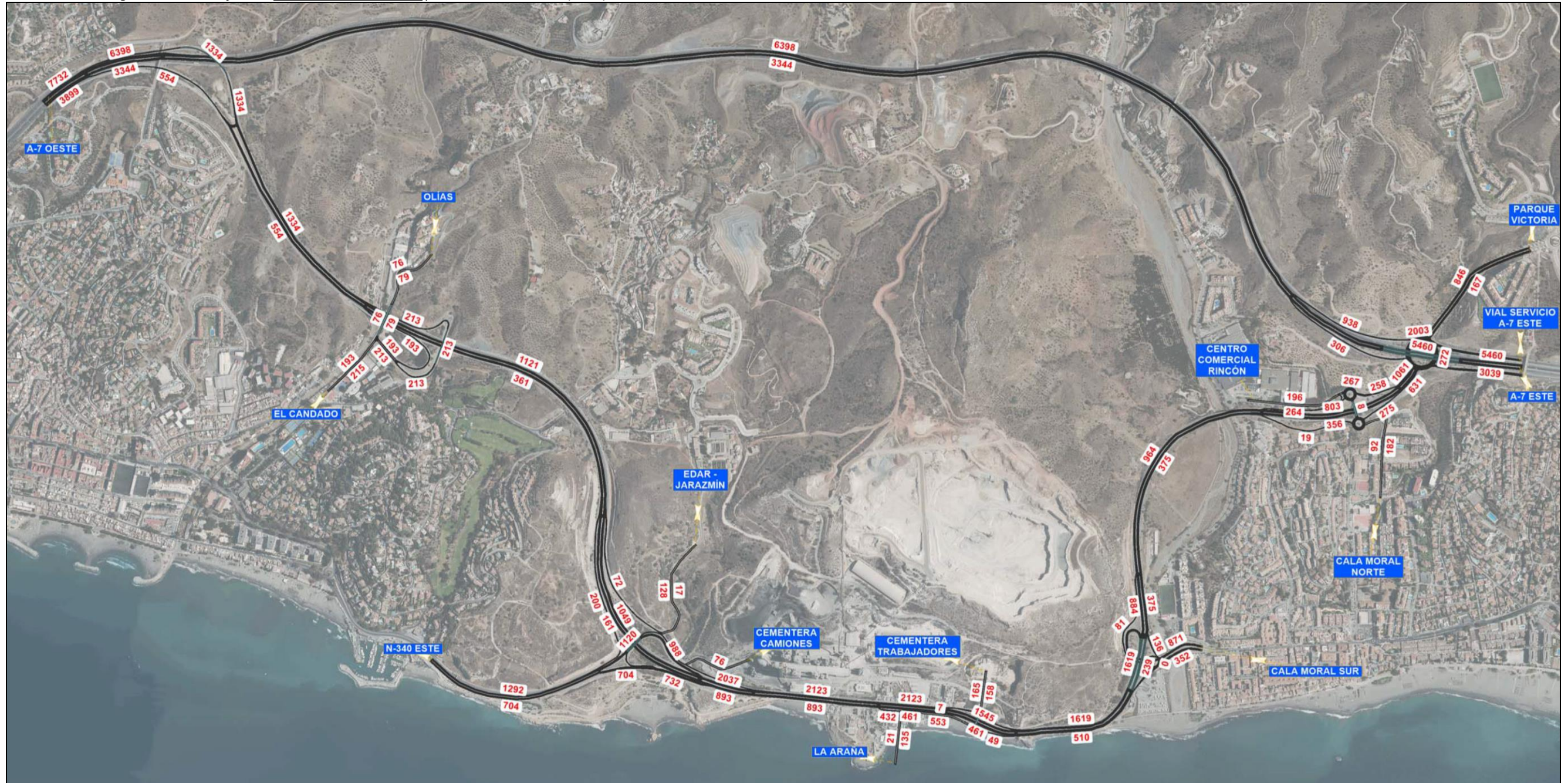
Ilustración 77: Asignaciones de Tráfico en Hora Punta de Mañana para el Año Horizonte (2046), sin incluir el desarrollo del Sector PAM-LE.7 "LA PLATERA".
