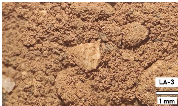
MUESTRA LA-3, IMAGEN DE LUPA BINOCULAR. DESTACA EL FRAGMENTO BLANQUECINO, PERTENECIENTE A UN MOLUSCO FRAGMENTADO Y EROSIONADO
