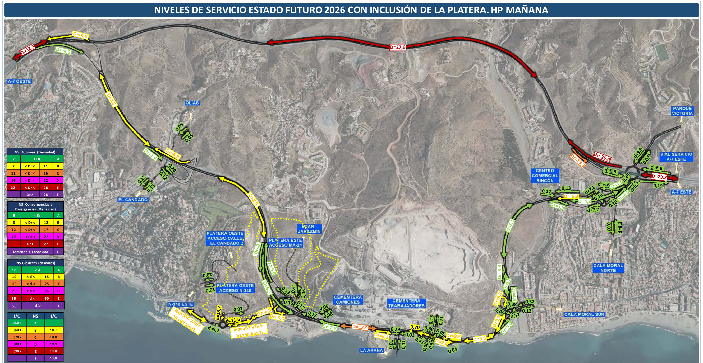
Ilustración 73: Niveles de Servicio en Hora Punta de Mañana para el Año de Puesta en Servicio (2026), incluyendo el desarrollo del Sector PAM-LE.7 "LA PLATERA".
