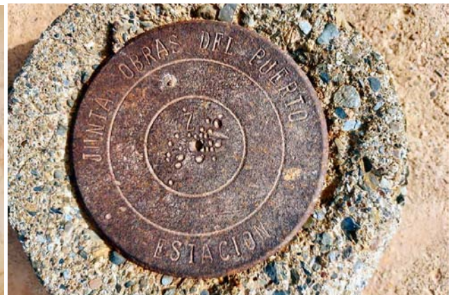
PUNTO TOPOGRÁFICO DE LA JUNTA DEL PUERTO
