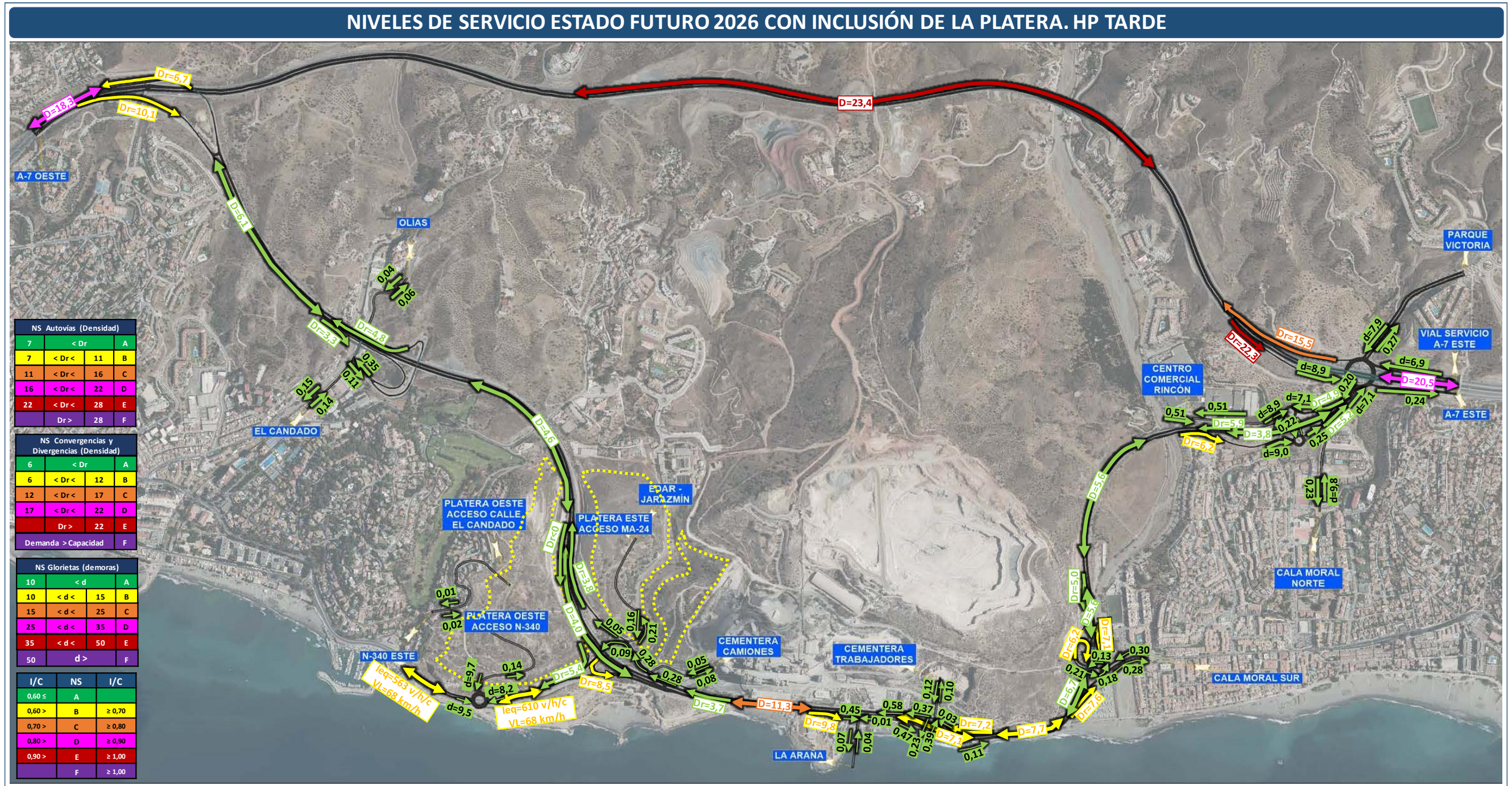
Ilustración 74: Niveles de Servicio en Hora Punta de Tarde para el Año de Puesta en Servicio (2026), incluyendo el desarrollo del Sector PAM-LE.7 "LA PLATERA".
